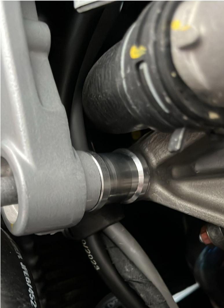
**Attenzione! Ricordiamo che sul lato sinistro lo spessore presente tra telaio e motore va reinserito quando viene montato il tampone con staffa Evotech.**
